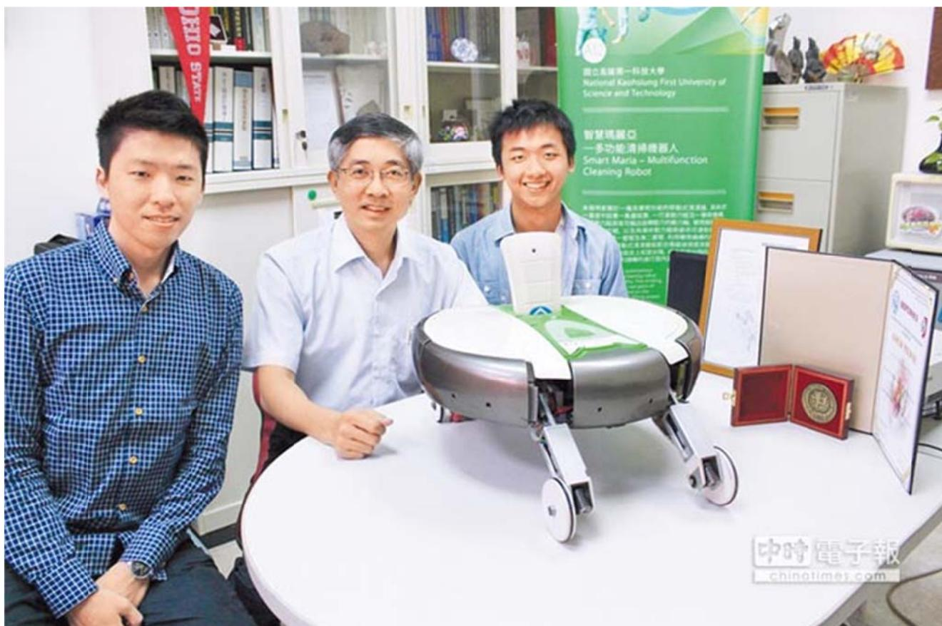
高雄第一科大機械系團隊研發的甲蟲外型清掃機器人，可跨越 10 公分以下的門檻障礙，同時能包辦居家守衛工作。（杜函霓攝）
