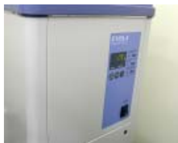
外接式循環冷卻水槽
