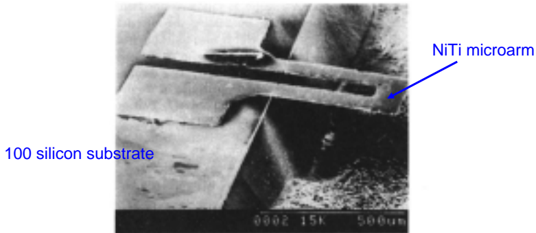
圖 5.61 NiTi 製之 SMA 微機械人的臂。感謝 the Yamaguchi 大學 (Faculty of Engineering)。
