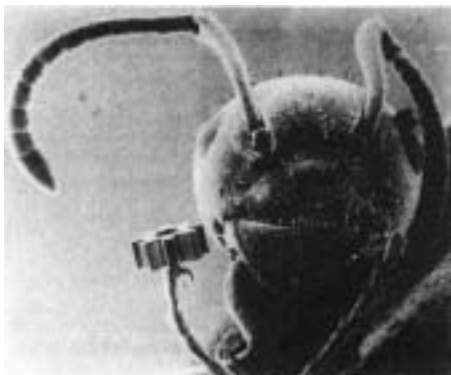
圖 4.32 由 LIGA 技術所製之微渦輪機之標齒輪 - 感謝 the Karlsruhe Research Center, IMT -
