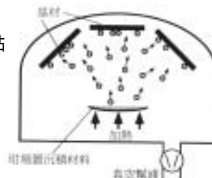
圖 3.3 蒸氣沉積法原理 - 根據 [Matl 95] 及 [Mem-95]
