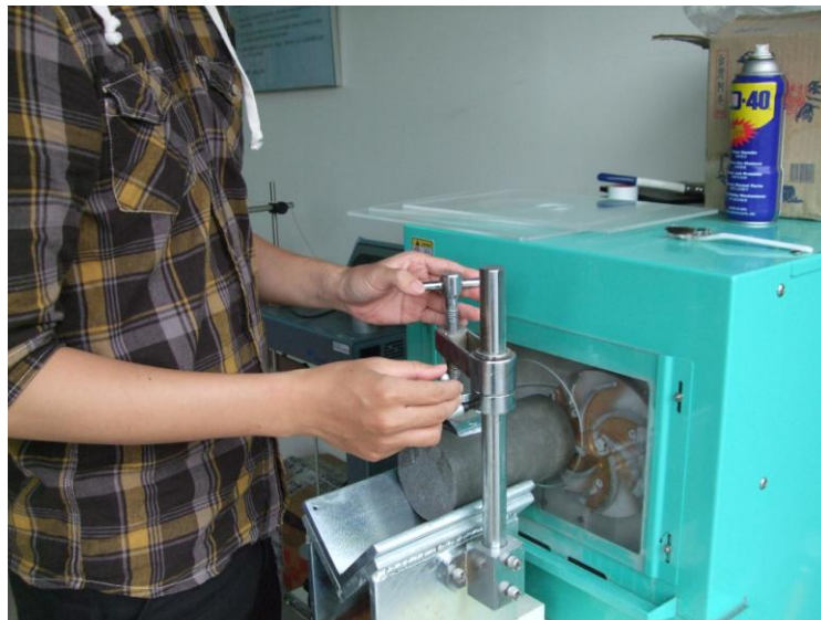
圖 8-1、混凝土快速研磨機試驗過程
