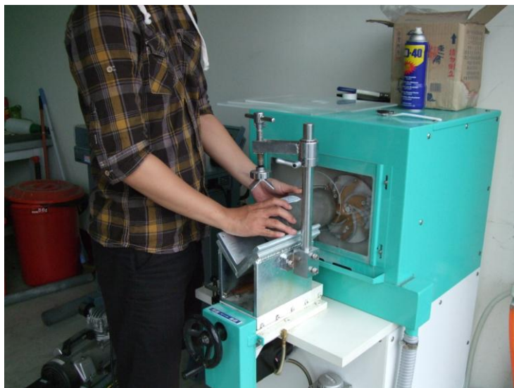
圖 8-2、混凝土快速研磨機試驗過程
