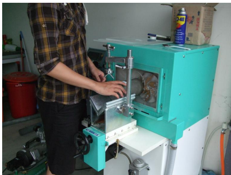
圖 8-3、混凝土快速研磨機試驗過程
